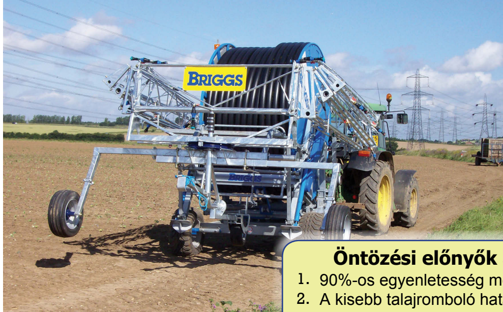
A konzol szárnyak rögzítése a dob, egyszerű és biztonságos
